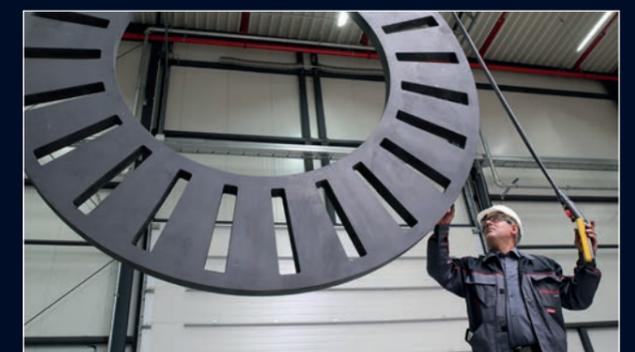
*Verteilerplatten aus KERA® 21 werden in Anlagen zur Herstellung von weißer Phosphorsäure verbaut.*
