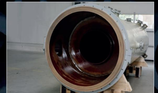
Kompletter HCl-Absorber aus KERA® SP 30 / GFK für außerordentliche Betriebsbedingungen. Hier 32 %ige Salzsäure (HCl), Betriebstemperaturen von bis zu 120 °C, ausgelegt für einen Betriebsdruck von -1,0 / + 0,5 bar.
