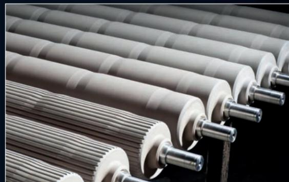
Laufwalzen aus KERA® SP 20 in der Cellulose-Verarbeitung, mit 20 %iger Schwefelsäure (H<sub>2</sub>SO<sub>4</sub>) als Prozessmedium und einer Arbeitstemperatur von 70 °C.
