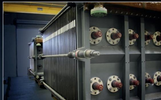
Das anfallende Nebenprodukt Salzsäure (HCl) wird während des Elektrolyseprozesses mit KERA® Rahmen in Chlorgas und Wasserstoff getrennt.
