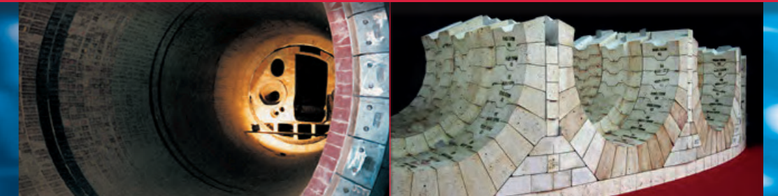
Bild oben: Blick in einen ausgekleideten Sonderabfall-Verbrennungsöfen
