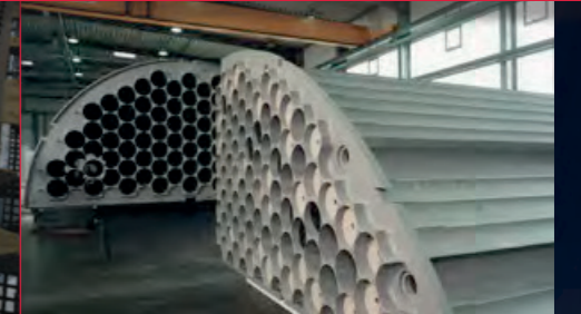
Rohrbündel für Nass-Elektrofilter aus schwerentflammbarem Polypropylen
