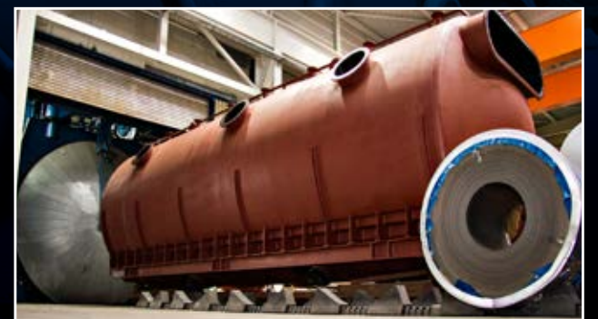
Gummierter Stahlbehälter nach Vulkanisation im Autoklav.
