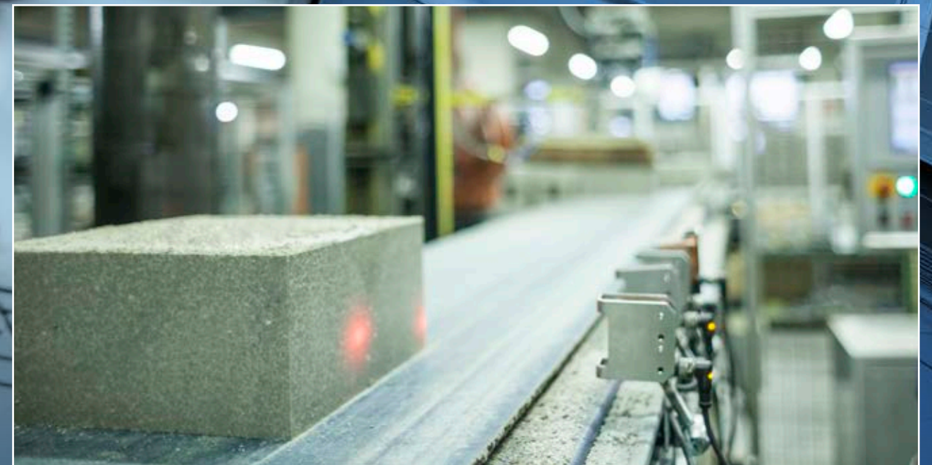
Optoelektronische Maßkontrolle in der keramischen Steinproduktion – damit es nachher passt.
