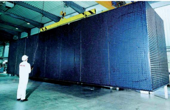
**Bild oben:** Mit einer werkseitig vorgefertigten Bekaplast™-Tauchwanne mit über 100 m³ Inhalt wird eine Salzsäurebeizanlage zeitsparend saniert.
